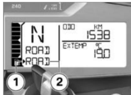
Der Auswahlpfeil **1** und der erste auswählbare Fahrmodus **2** werden angezeigt.
