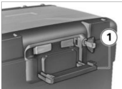
**!** Wird der Tragegriff zugeklappt, wenn das Topcaseschloss waagrecht steht, kann die Verriegelungslasche beschädigt werden. Vor dem Zuklappen des Tragegriffs darauf achten, dass das Topcaseschloss senkrecht steht.◀
