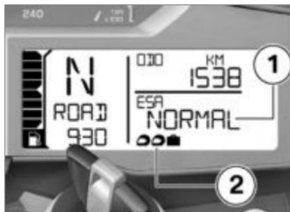
Die Dämpfung wird im Multifunktionsdisplay im Bereich **1** angezeigt, die Federvorspannung im Bereich **2**.
