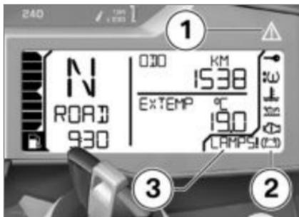
Warnungen, für die keine eigenständige Warnleuchte zur Verfügung steht, werden durch die allgemeine Warnleuchte **1** in Verbindung mit einem Warnsymbol im Bereich **2** oder mit einem Warnhinweis im Bereich **3** dargestellt. Abhängig von der Dringlichkeit der Warnung leuchtet die
