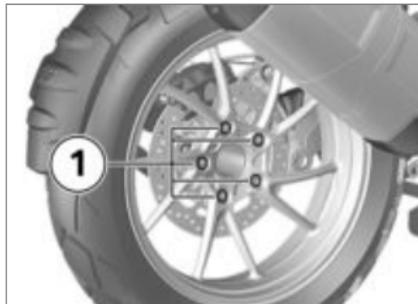
**!** Die Längen der Radschrauben von Speichenrad und Gussrad sind unterschiedlich. Vermischen oder Vertauschen der Radschrauben führt zu man-
