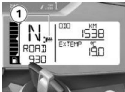
Die Lenkergriffe können in zwei Stufen beheizt werden. Die eingestellte Stufe wird im Multifunktionsdisplay an Position **1** angezeigt.
