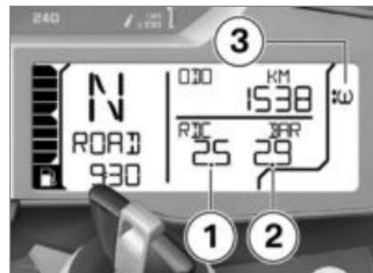
Die angezeigten Reifenfülldrucke beziehen sich auf eine Reifentemperatur von 20 °C. Der linke Wert **1** gibt den Fülldruck des Vorderrads an, der rechte Wert **2** den Fülldruck des Hinterrads. Unmittelbar nach Einschalten der Zündung wird -- -- angezeigt, da die Übertragung der Fülldruckwerte erst nach dem erstmaligen Überschreiten einer Geschwindigkeit von 30 km/h beginnt.
