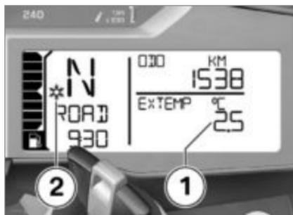
Bei Außentemperaturen unter 3 °C besteht die Gefahr von Glatteisbildung. Beim erstmaligen Unterschreiten dieser Temperatur wird unabhängig von der Displayeinstellung automatisch auf die Außentemperaturanzeige **1** umgeschaltet, der angezeigte Wert blinkt.
