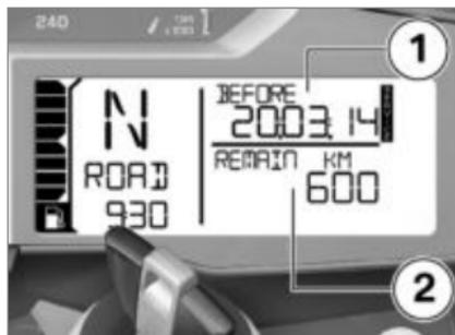
Liegt die verbleibende Zeit bis zum nächsten Service innerhalb eines Monats, oder wird der nächste Service innerhalb von 1000 km fällig, so werden das Servicedatum **1** und die verbleibenden Kilometer **2** im Anschluss an den Pre-Ride-Check für kurze Zeit angezeigt.
