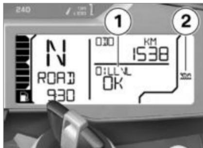
Der Ölstandshinweis **1** gibt Auskunft über den Ölstand im Motor. Er kann nur bei Fahrzeugstillstand aufgerufen werden.
