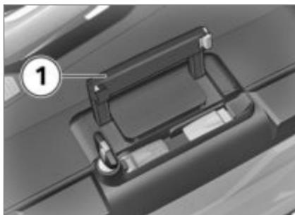
**!** Wird der Tragegriff zugeklappt, wenn das Kofferschloss längs zur Fahrtrichtung steht, kann die Verriegelungslasche beschädigt werden. Vor dem Zuklappen des Tragegriffs darauf achten, dass das Kofferschloss quer zur Fahrtrichtung steht. ◀
